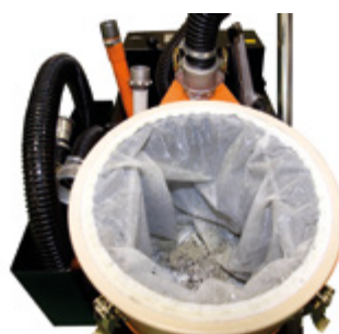
Filtrovní vložka s třískami a kalem po broušení
