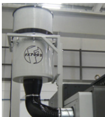
Montáž na stojany a boční nasávání
