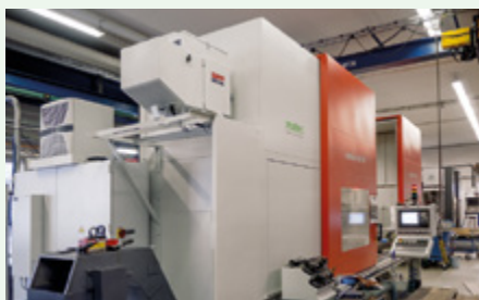
UC2-SDIII s filtrační vložkou na nánosy, boční odsávání
