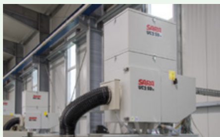
UC2-SDIII s filtrační vložkou na nánosy, montáž na stroji
