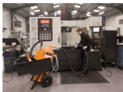
Nasávání znečištěné emulze, třísek a kalu po broušení
