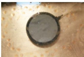
Výsledek: žádný uzavřený olejový povlak
